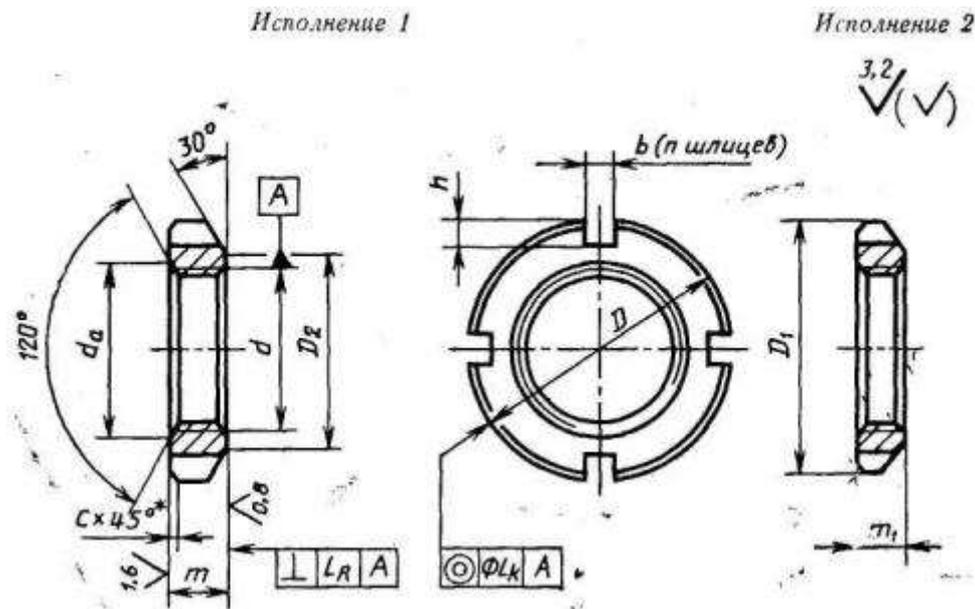
\* Допускается вместо фаски скругление радиусом R = c и отсутствие фаски для исполнения 2.
